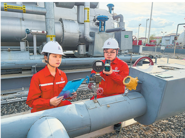
东北油气分公司聚焦智能油气田建设,以智能化手段加强基层站场和作业现场安全隐患排查,保障油气田设备平稳运行。图为6月4日松原采油厂员工使用手持式激光甲烷检测仪对集气站密封点进行监测。
