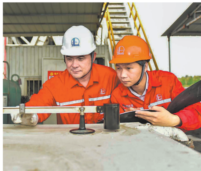
中原石油工程现场工程师正在测量钻井液比重。 程相东 摄
