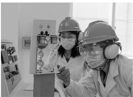
山西晋中石油油库质检中心员工正在进行柴油十六烷值检测实验。
