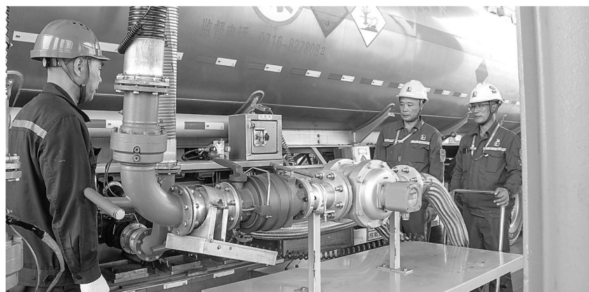
湖北石油荆州油库计量员使用流量计撬装小车载线自校装置校验发油精度。刘泉摄
