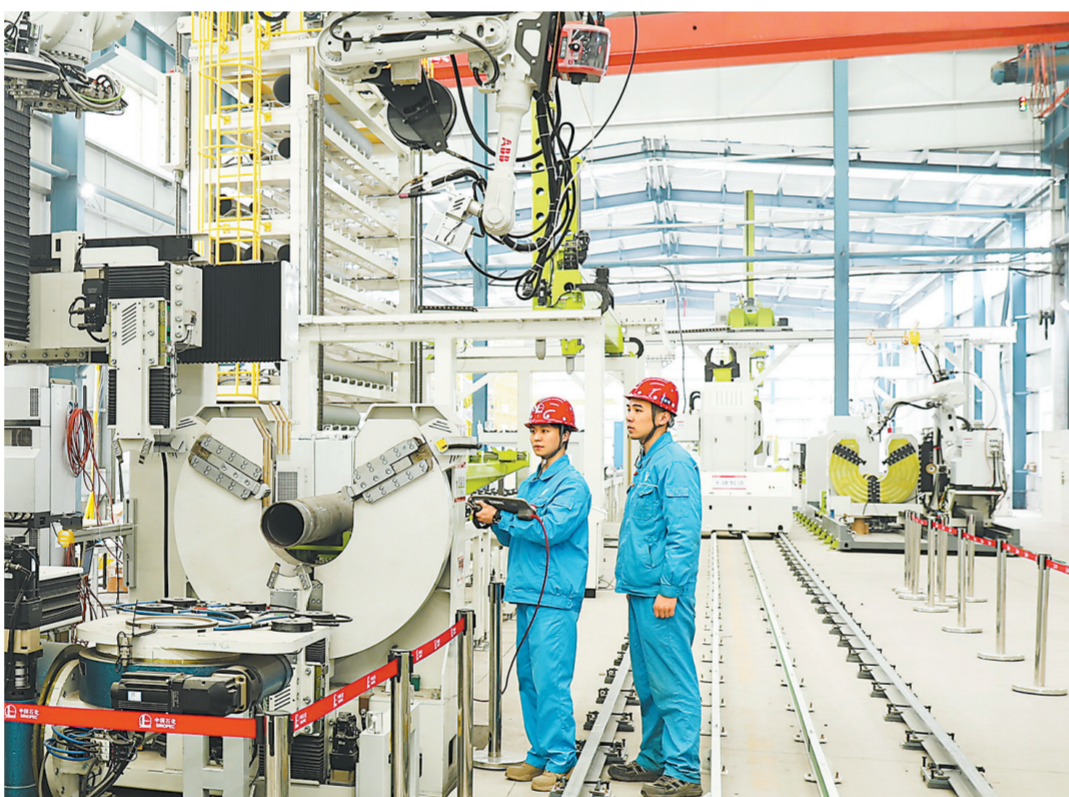
▲十建公司研发的国内首条管道智能预制生产线投入运行,17台(套)智能装备协同联动,实现自动上料、智能组对、机器人焊接等智能化预制目标,年管道预制生产能力可达20万米。图为4月16日十建公司研发人员对管道智能预制生产线运行状态进行检查。田元武摄
