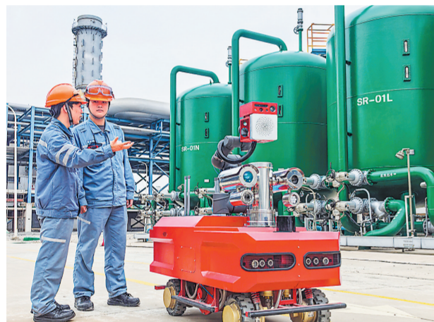
▲镇海炼化围绕工业生产外操无人化智能化场景应用,部署“飞索”“汪大师”等巡检机器人,实现特定区域的全天候自动巡检,巡检数据实时上传至控制后台,远程监控设备状态,有效增强安全保障能力。图为4月15日操作人员调试公用系统轮式机器人。何雯摄 刘倩欣文
