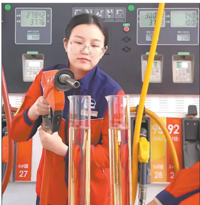
江西南昌石油员工田昕雨在加油站现场演示捏枪是否影响出油量。
