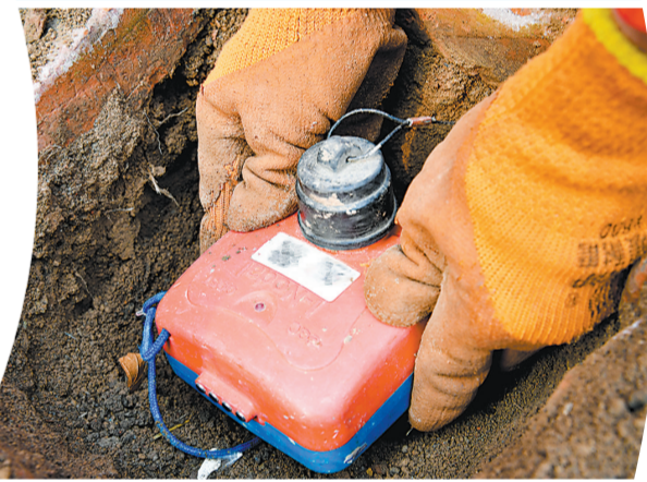
物探队员将无线节点仪埋置在合适深度。
