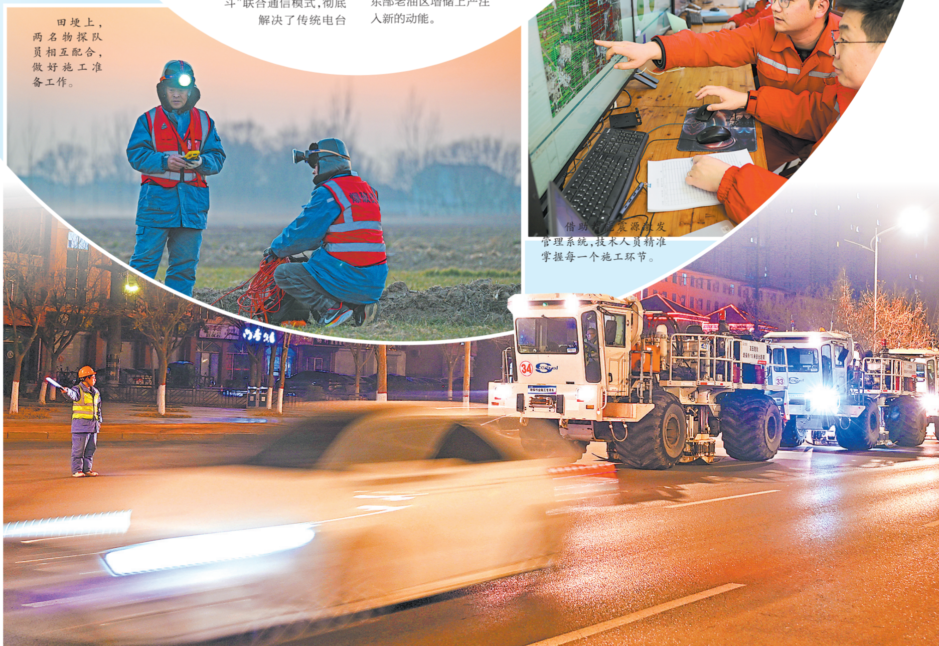
深夜,大型可控震源车有序穿过城市街道。
