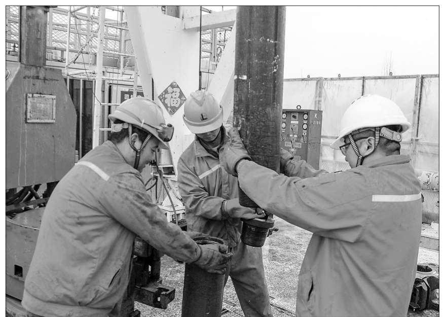
为全面提升基层单位安全管理水平,中原石油工程公司建立了一套动态调整、精准帮扶的闭环管理机制,每月结合现场检查情况与日常管理实际,对基层单位实施“一对一”精准帮扶,确保管控对象精准、问题排查精准、帮扶措施扎实有效。图为2月27日,钻井一公司帮扶干部(右)在40583钻井队施工现场协助员工进行组合钻具作业。 魏国军 李博达 摄影报道
