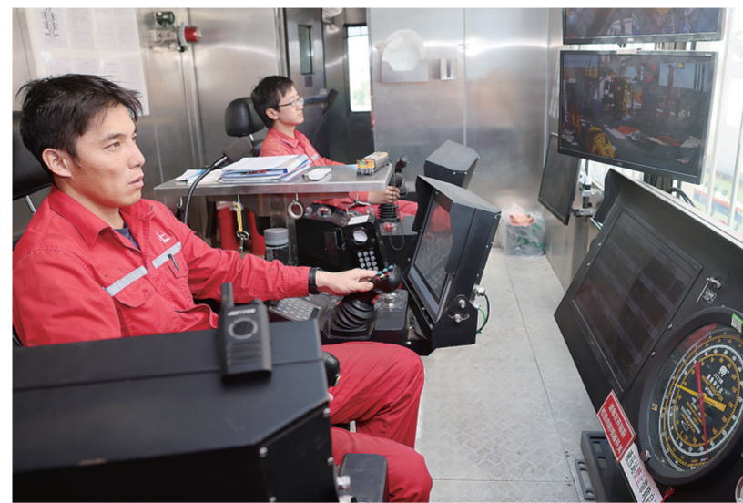
胜利石油工程公司70183钻井队员工在一体化司钻房通过双司钻操作系统 进行起钻作业。
