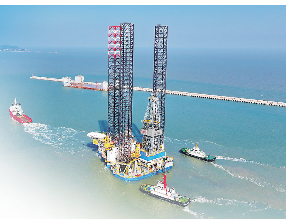
胜利石油工程公司新胜利三号平台正在进行拖航作业。
