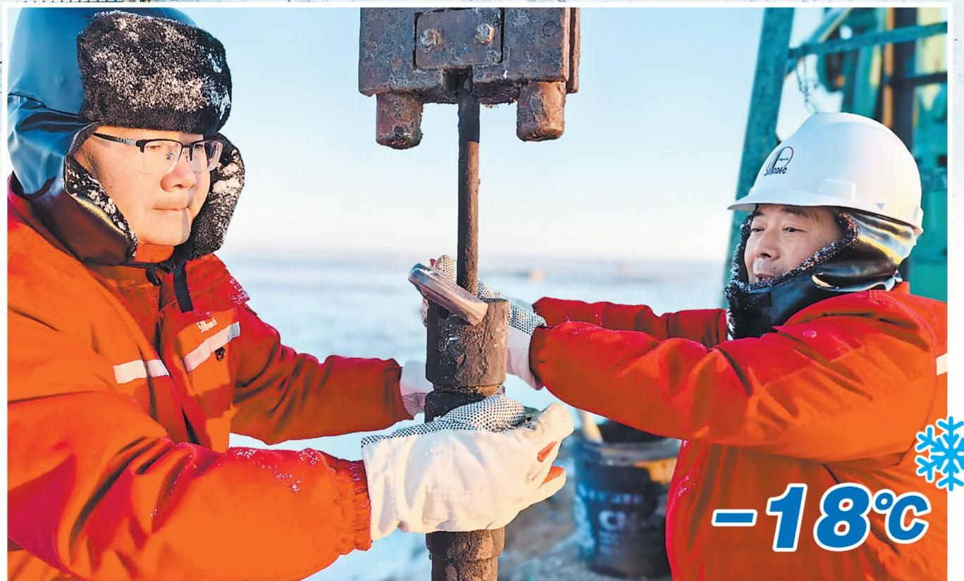
新年伊始,华北油气分公司采油一厂采油管理五区所在的宁夏盐池县大水坑镇迎来降雪。管理区严格落实领导带班和24小时值守机制,组织员工加强对关键区域设备的巡查,建立隐患整改闭环台账,全力保障设备稳定运转。图为管理区员工合力紧固抽油机盘根盒。
