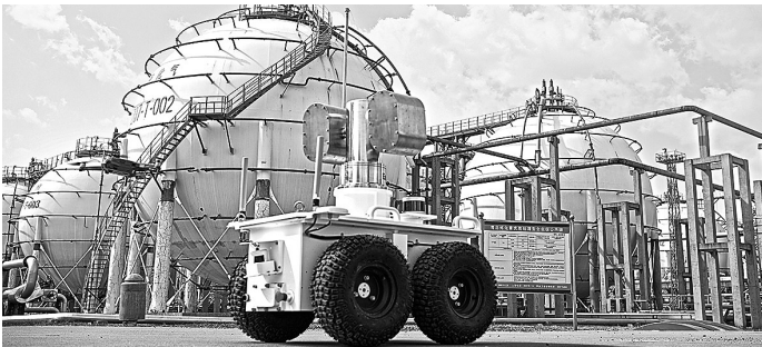
青岛炼化智能巡检机器人在储运罐区现场巡检。刘强 摄
