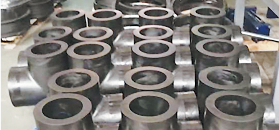
用上海石化核电管材专用料YGH041TLSH生产的8英寸三通。 钟 峰 供图
