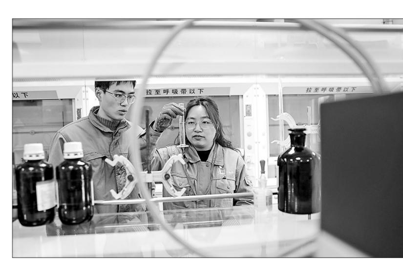
今年以来,扬子石化质检中心青年攻关团队围绕精制汽油及原料油分析需求,对现有分析方法进行系统优化,创新采用近红外光谱法替代部分传统分析手段,实现汽油多项指标快速稳定检测。该方法具有分析速度快、安全性高、无污染等优势,大幅降低检验成本。图为12月24日扬子石化质检中心青年攻关团队开展分析实验。
