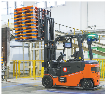
智能叉车正在根据包装线需求向托盘仓自动补充空托盘。
