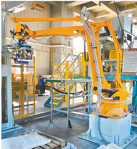
扬子石化 2 号聚乙烯装置机械臂进行助剂无人添加。
