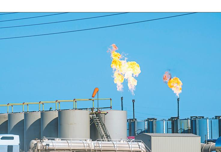
监测。净热值是评估设备性能与燃烧效率的关键指标,设备维护不及时可能导致甲烷未充分燃烧而直接排入大气。
