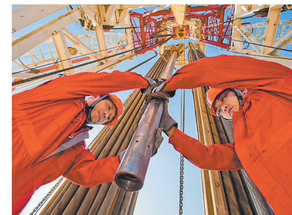
经纬公司胜利测井公司员工正在进行超高温高压测井仪器入井作业。
