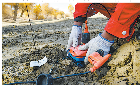
随着技术发展,无线节点作业取代了传统的有线施工。图为放线人员埋置地球物理公司自主研发的I-Nodal节点仪。
