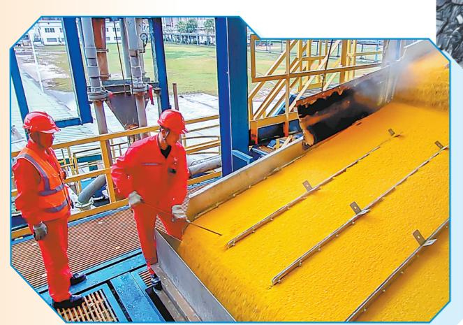
中原油田普光气田是当前国内最大的硫黄生产基地,其硫黄纯度高达99.99%,被称为化工领域的黄金。图为员工在清理脱水振动筛,以增强硫黄脱水效果。 汪作庆 摄
