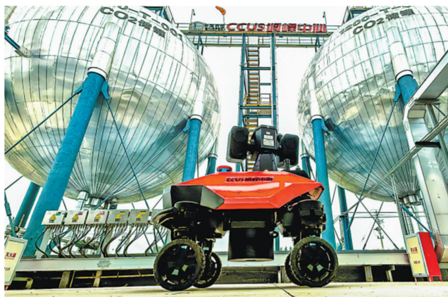
华东石油局CCUS调峰中心巡检机器人在站区巡检。
