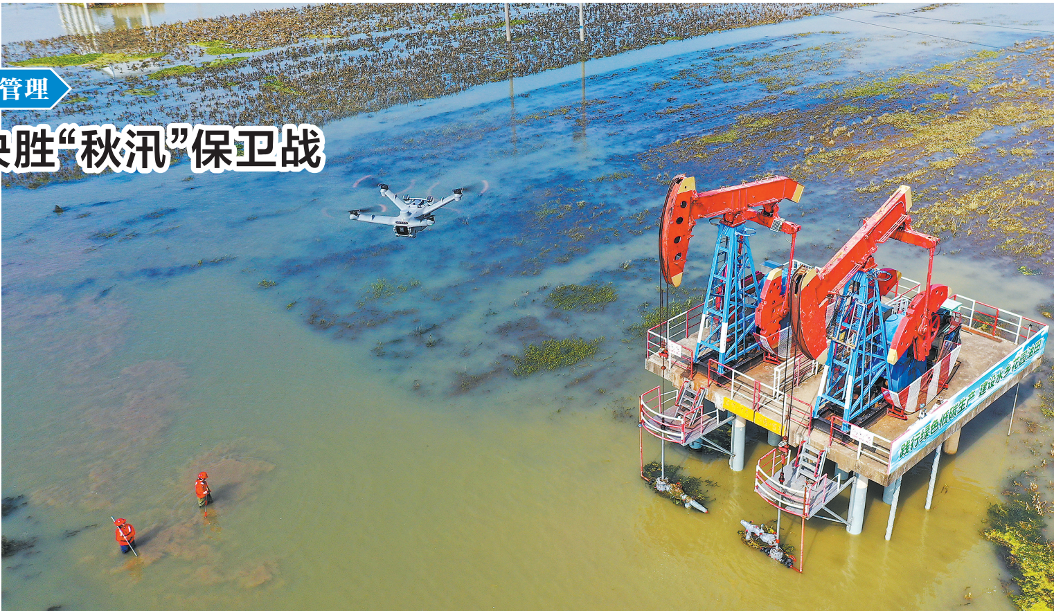
位于洪泽湖泄洪道的江苏油田高集油区一片汪洋。为保障安全环保生产,采油二厂应用无人机巡检,搭载高清摄像头、红外热像仪、激光雷达等设备,对抽油机进行全方位监测。
