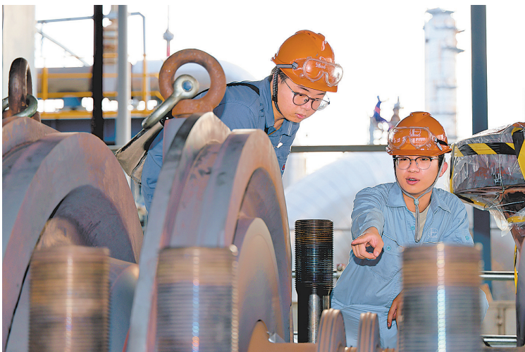
乙烯裂解气压缩机机组拆解后,设备人员仔细检查零件规范保护情况。
