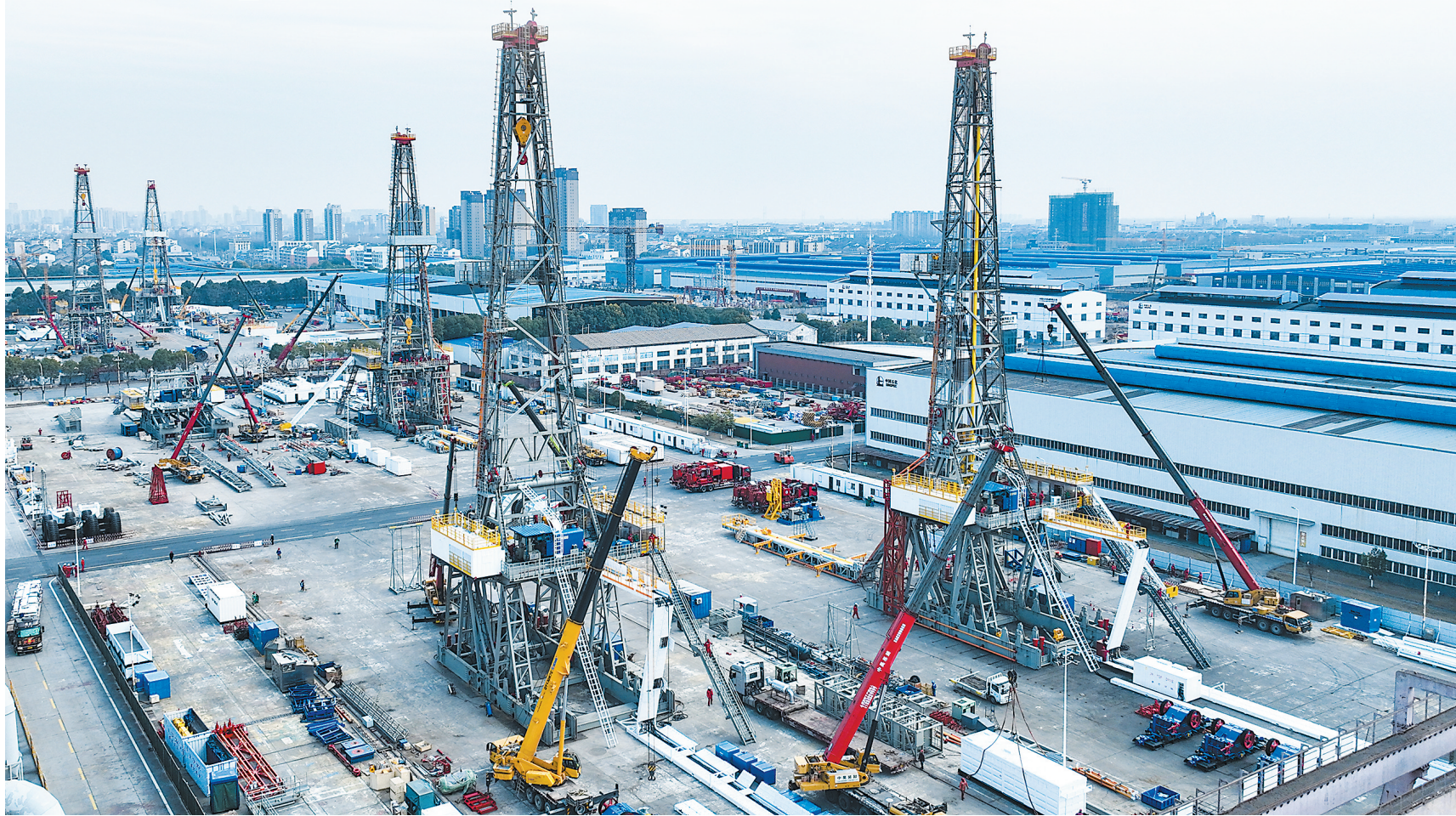
多部9000米钻机在石化机械四机公司钻修装备试验场进行组装,并开展井架底座起升、自动化机具功能验证等试验,待用户验收后装车发运。
