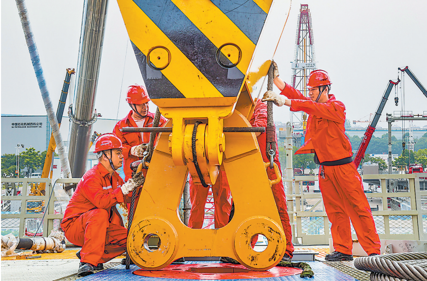
操作人员在组装9000米钻机大钩,大钩是连接钻机提升系统与井下工具的关键承载装置,最大钩载6750千牛顿。
