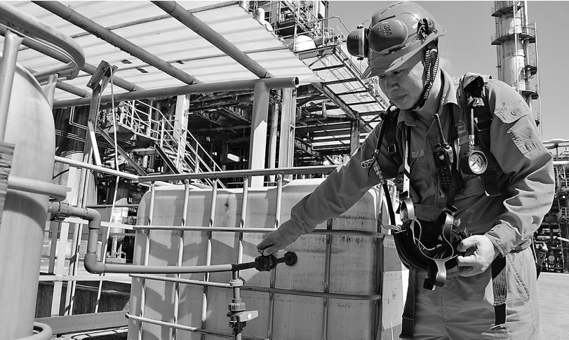
在中原油田普光分公司天然气净化厂第六联合装置现场,攻关小组成员、高级技师何修辉利用胺液净化回收器处理含杂胺液。孙莞竹 摄
