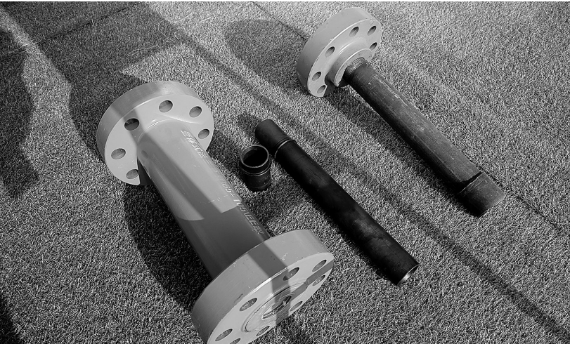
左侧为加装高压防刺套后的缓冲短节,右侧为改造前的缓冲短节。张远鹏 摄
