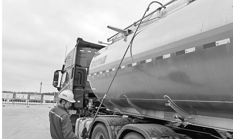
湖北石油荆州油库安检员使用手持检测仪检查油罐车顶部计量口气密性。唐珊 摄
