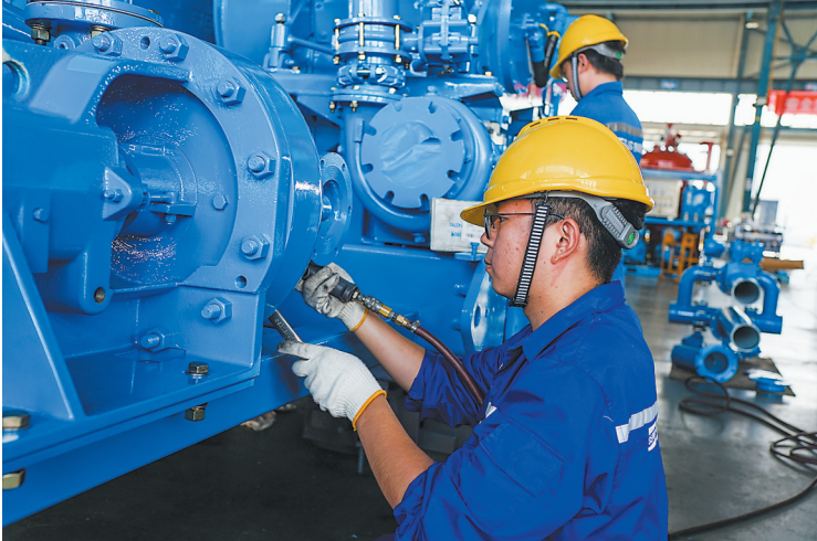
图为石化机械公司员工正在装备双机双泵固井橇。
