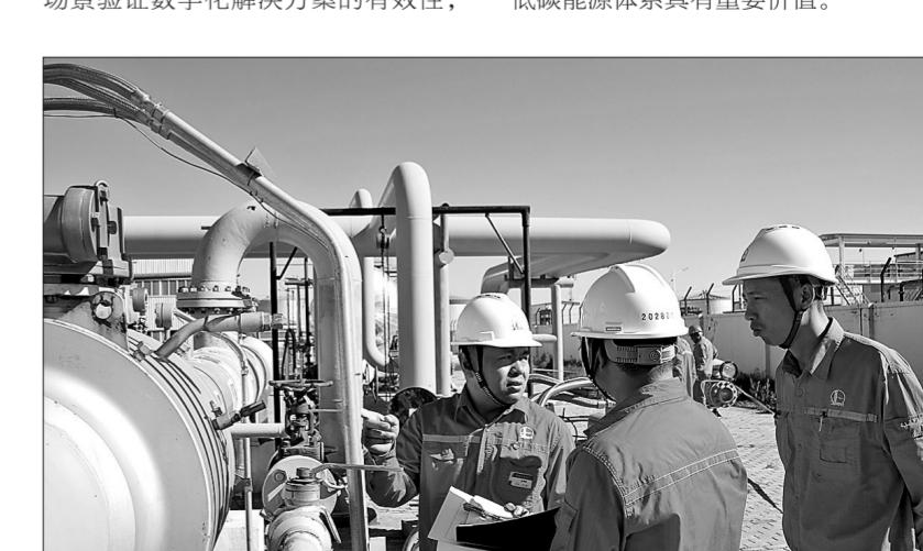
华北油气分公司东胜气田扎实开展安全隐患排查整治“雷霆行动”,聚焦安全隐患标识、设备泄漏风险等重点,开展生产现场操作和施工作业隐患排查整治,全力保障生产安全稳定运行。图为8月30日气田员工在集中处理站电动节流阀更换作业中进行安全检查。
