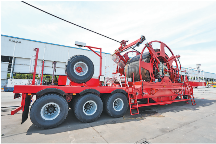
石化机械研制的世界首台SLG630D全电驱自动化连续管作业装备即将用于非常规油气开发。 卢鹏 摄
