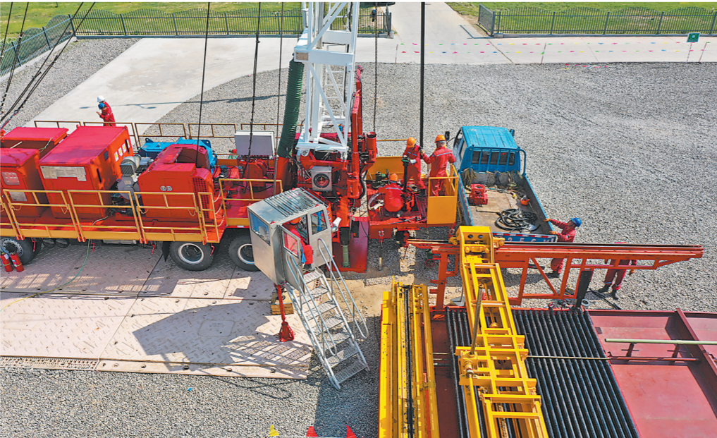
胜利油田辛25斜20井现场,油气井下作业中心东辛作业区的员工正在对全电驱自动化修井机做施工前的调整准备。 朱克民 摄
