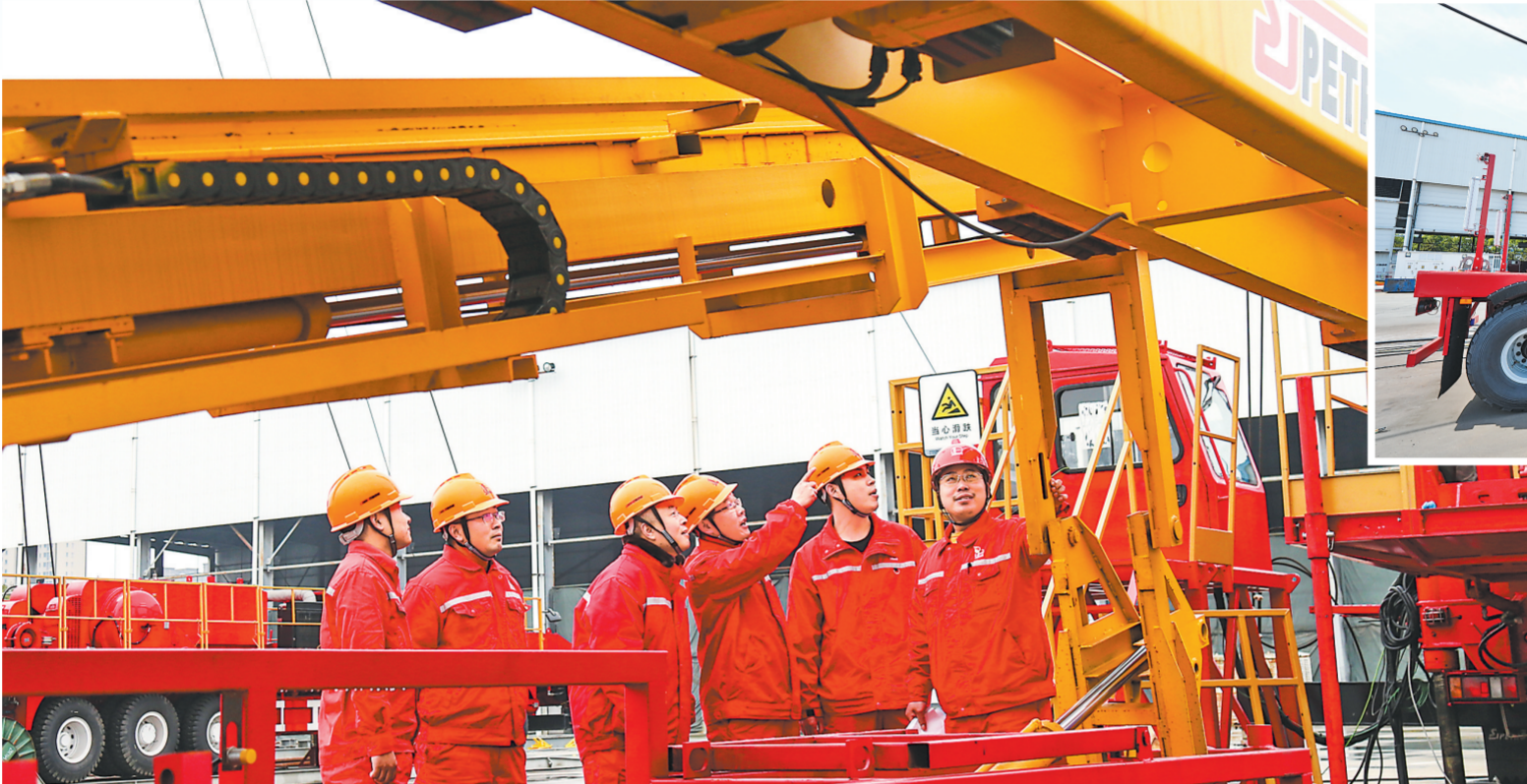
动力猫道装置主要用于石油钻采作业,替代人工完成管柱从地面至钻台面双向自动输送工作。图为石化机械四机公司技术人员讨论优化装置设计。 李国荣 摄
