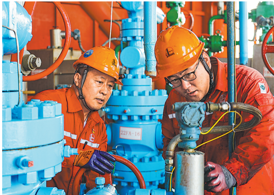
胜利油田CB22F平台严格海上注聚日常管理,从落实巡检制度,密切监控生产情况,确保海上化学驱开发工作安全高效进行。图为8月中旬,平台员工检查注聚井口压力。
