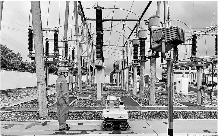
变电站智能巡检机器人在江汉油田涪陵页岩气田江汉110千伏变电站巡检。 李东勇 摄
