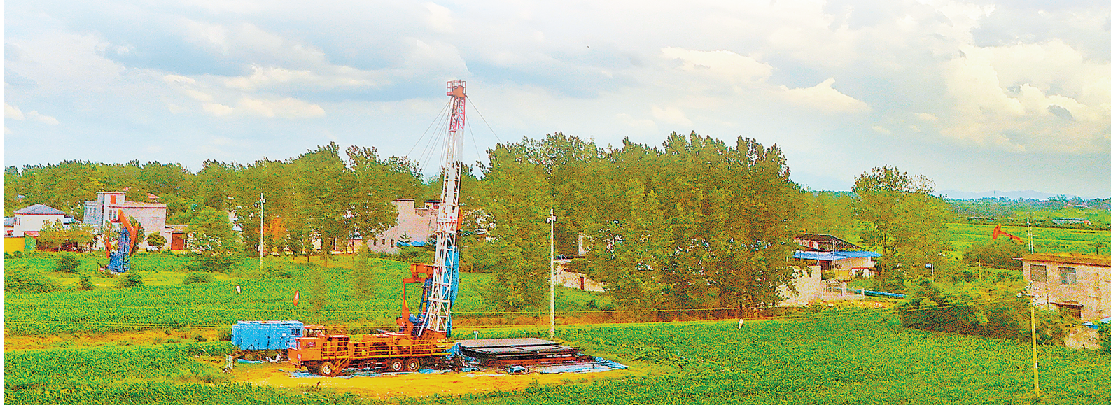
河南油田创新工艺,用小修装备开展复杂井大修作业,减少外委作业费。
