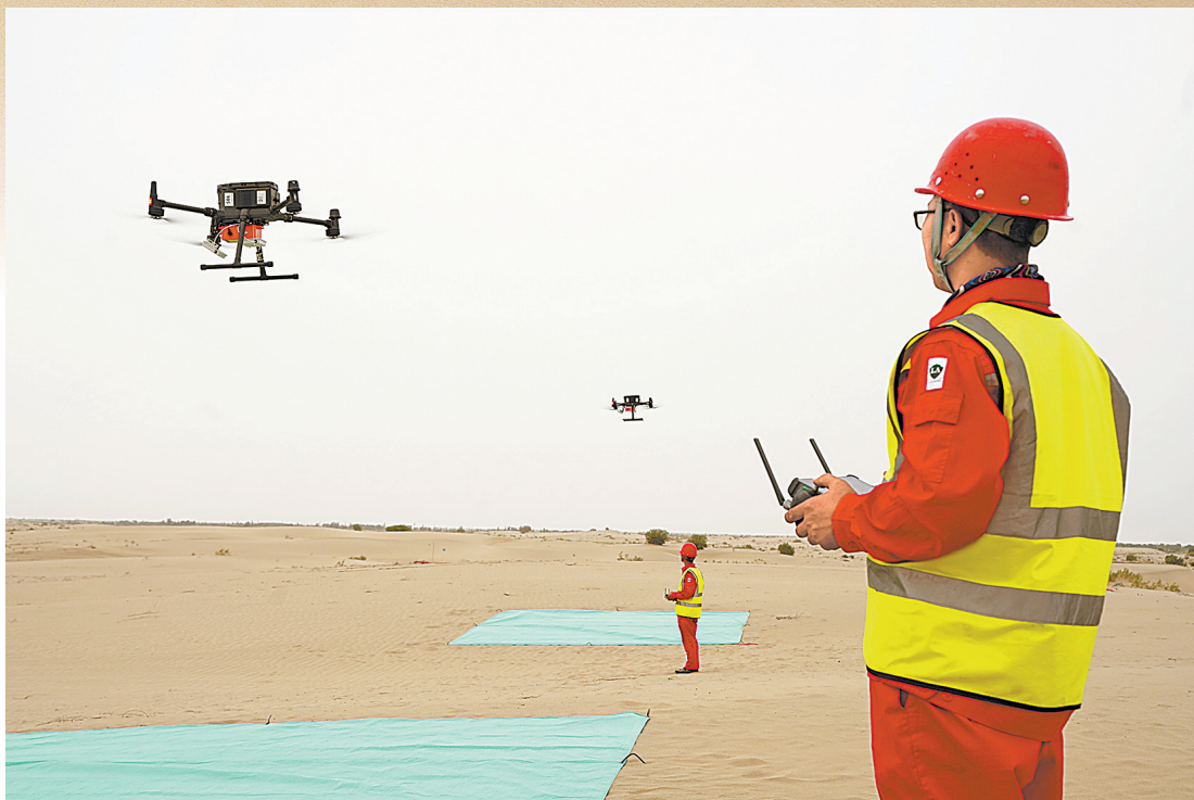
无人机节点质控巡线既安全又快捷。SGC2106队投入6架无人机,全面替代传统人工徒步巡线方式。
