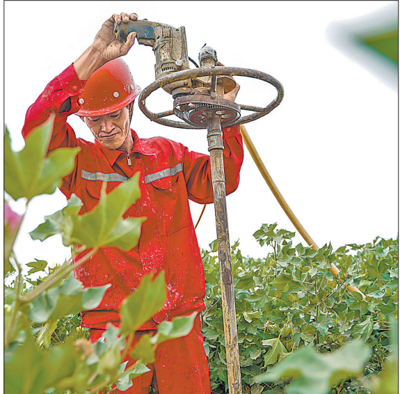
手摇钻农田作业时,遇盐碱硬层影响钻井时效,钻井工采用锥形钻头和合金钻头接替钻进方案,成功解决这一难题。
