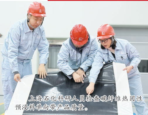
上海石化科研人员使用热固预浸料进行碳纤维复合材料实验。
