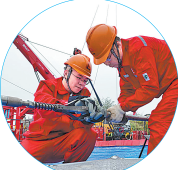
胜利工区施工现场，经纬公司技术人员正在对接检查套变检测仪器，精准检测套管漏失位置和损伤情况。 张兴杰 摄
