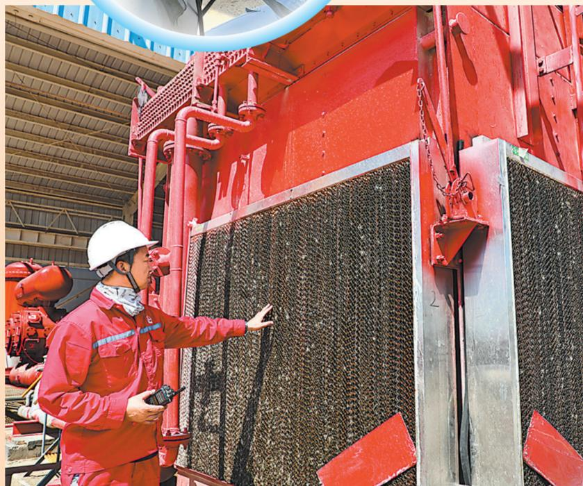
西北油田采油二厂在二号联合站和轻烃站的8台压缩机组中，创新应用了自循环式水帘降温系统。该系统通过水循环蒸发原理，有效降低设备运行温度。
