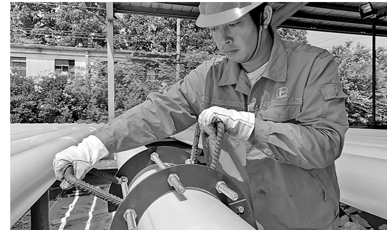
防腐管道项目组操作工李大刚使用自主研发的聚氨酯保温管切割器切割保温管。
