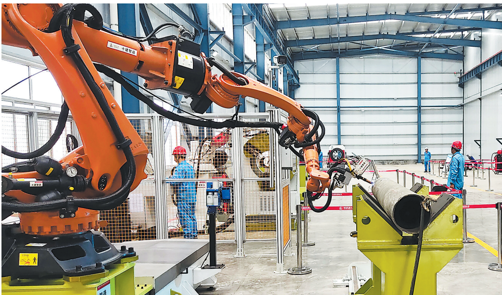
十建公司研发的国内首台九轴全位置智能焊接机器人正在进行管道焊接作业
