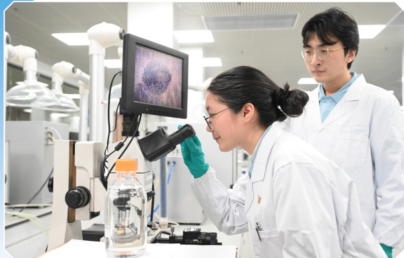
质检人员在进行生物航煤产品出厂前的磨痕直接分析。
