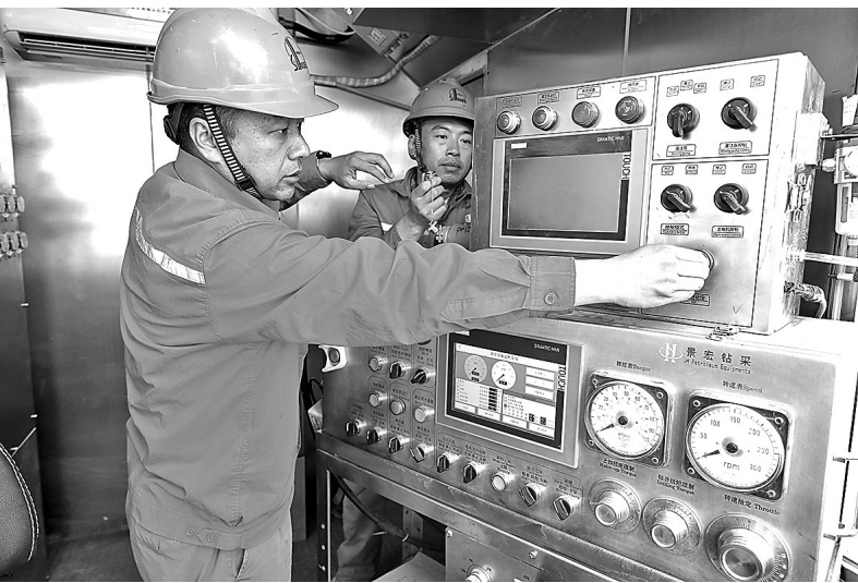
临盘钻井项目管理部电气工程师廖思檬(右)和40662队刘海防在司钻房调试互锁装置。
