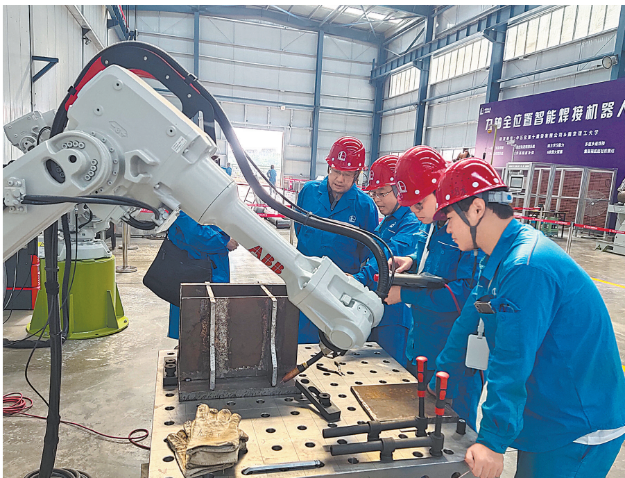
十建公司将数字化管理平台系统与智能焊接机器人互联互通。
