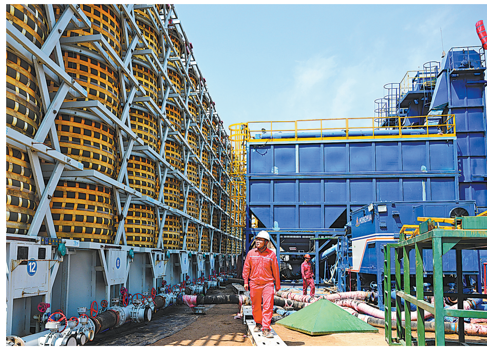
华东油气延川南煤层气田在W75平台煤层气井储层改造中首次应用自动加砂系统。
