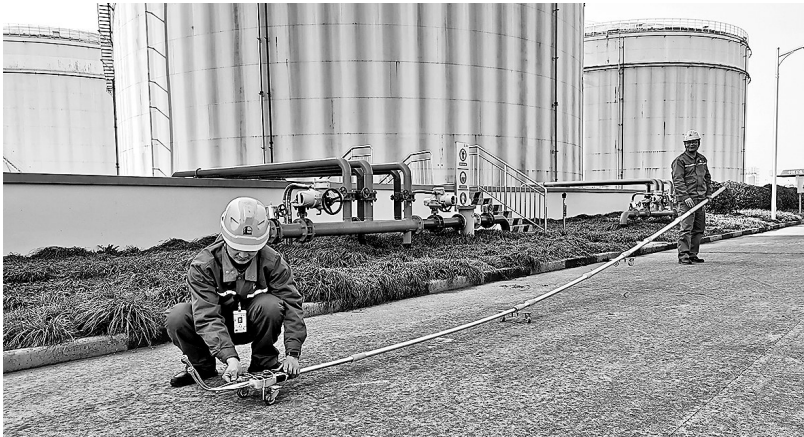
浙江绍兴油库员工夏威(左)和张晓武拿起自制的检测杆准备对储罐内的可燃气体浓度进行检测。
