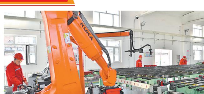
中原油田油管杆自动化修复基地新引进抽油杆上接箍机器人,可实现抽油杆自动选择、螺纹精准柔接,自动完成抽油杆接箍上卸扣等工作。图为近日该机器人正在进行作业。
