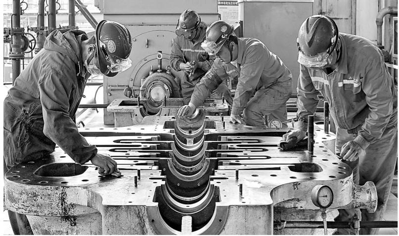
当前，九江石化生产装置大检修工作正处于关键阶段。全体干部员工从严抓牢安全管理、质量管控和现场服务，通过强化过程监督、细化责任分工、优化资源配置等举措，全力以赴打好检修改造攻坚战。图为3月24日，维修人员对小主风机组及齿轮箱表面污垢进行清理。
