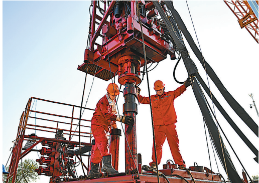
胜利油田东辛采油厂管二管理区员工与专业化单位员工密切配合,在管14斜52井开展自喷转抽措施。 朱克民 摄
