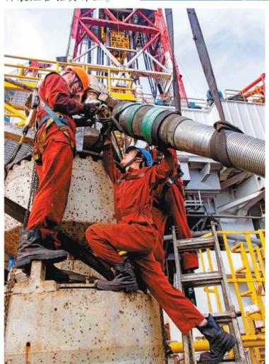
水下班组员工更换水下防喷器阻流压井铰链软管。
