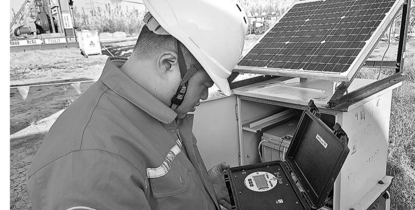
胜利油田油藏动态监测中心对齐鲁石化—胜利油田百万吨级CCUS示范区制定油藏监测方案，克服油藏深、温度高等困难，成功利用高精度温度压力仪器对井下动态数据进行实时监测，指导工程技术人员优化压裂方案。图为11月5日该中心员工监测该区3500米深油井的数据。
