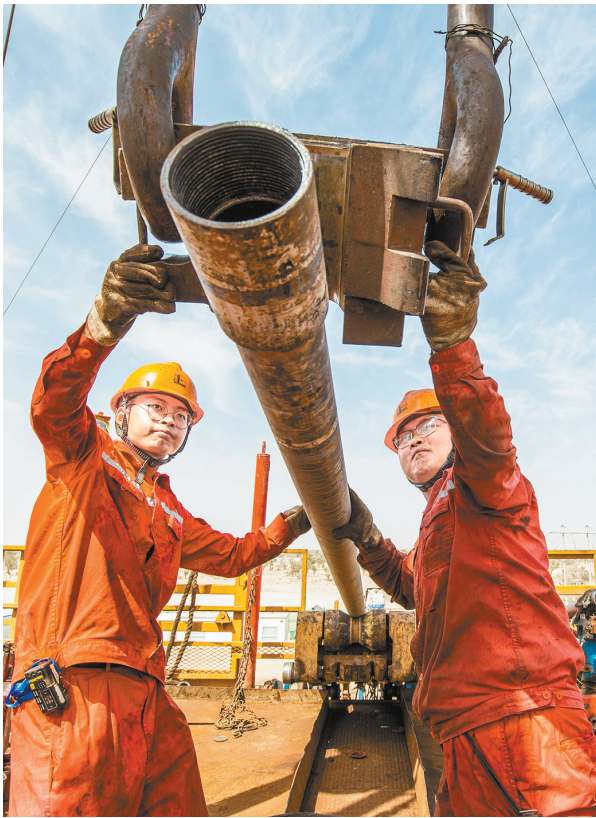
两名青年员工在万米修井机平台合力进行超深井筒修复作业。
