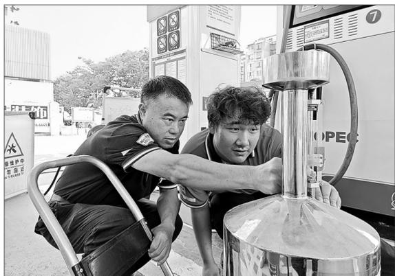
9月全国质量月期间,为加强对加油机的计量管理,确保加油机发油准确,贵阳花溪石油对辖区内13个加油站全面开展加油机自校工作,通过标准解读检测计算,严格控制油品损耗。图为9月6日,贵阳花溪长吉加油站经理(左)班一仁教新员工读取标准罐数据。 连彩云 摄
