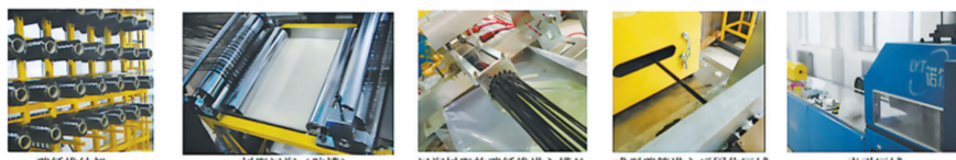
碳纤维纱架 树脂浸渍(胶槽) 浸渍树脂的碳纤维进入模具 成型碳纤维进入后固化区域 牵引区域
