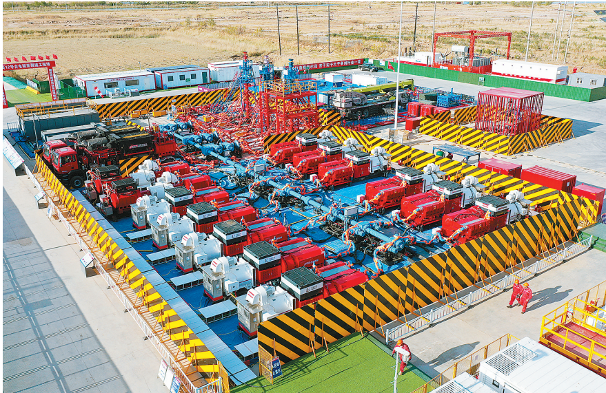
胜利油田民丰区块12号台正在进行3口页岩油井的压裂施工。
