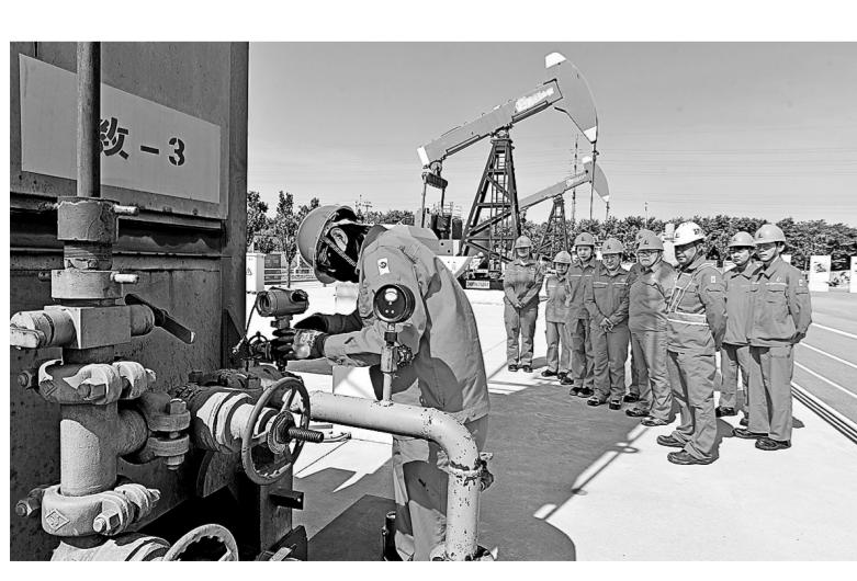
胜利油田河口采油厂坚持基本功训练从实战中来、到实战中去,3月以来,陆续对3000名外闯市场后返岗的采油工和集输工进行培训,帮助他们更熟练地掌握采油和集输相关工作的最新技术和操作方法,提高工作效率和质量。图为5月29日,该厂返岗采油工学习无线压力温度变送器的更换方法。吴木水 摄 丁洁文
