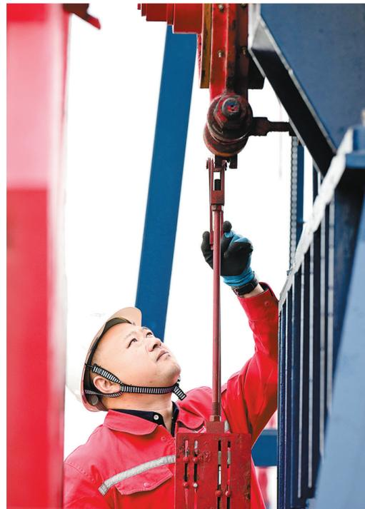
沈霁在现场检查抽油机远程刹车系统的运行状况。
