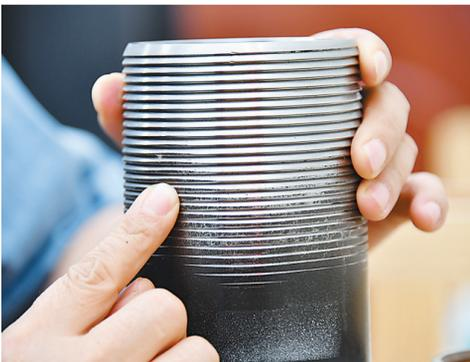
吕庆钢用手指反复触摸油管短节外螺纹,检查其磨损情况。
