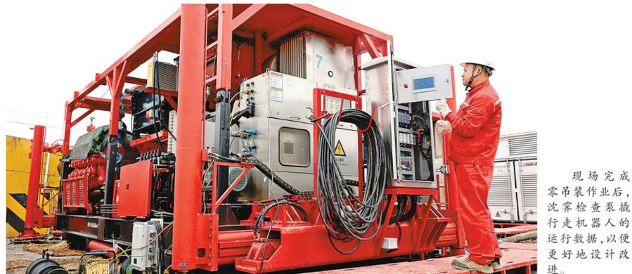
现场完成零星吊装作业后,沈霁检查泵撬行走机器人的运行数据,以便更好地设计改进。
